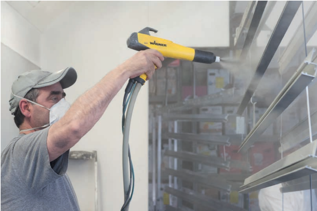
Nahezu jede Lackier- und Pulverbeschichtungsanlage sowie Nebeneinrichtungen sind explosionschutzrelevant und vor allem nicht nur einmalig, sondern wiederkehrend zu prüfen. Foto: Qubus
